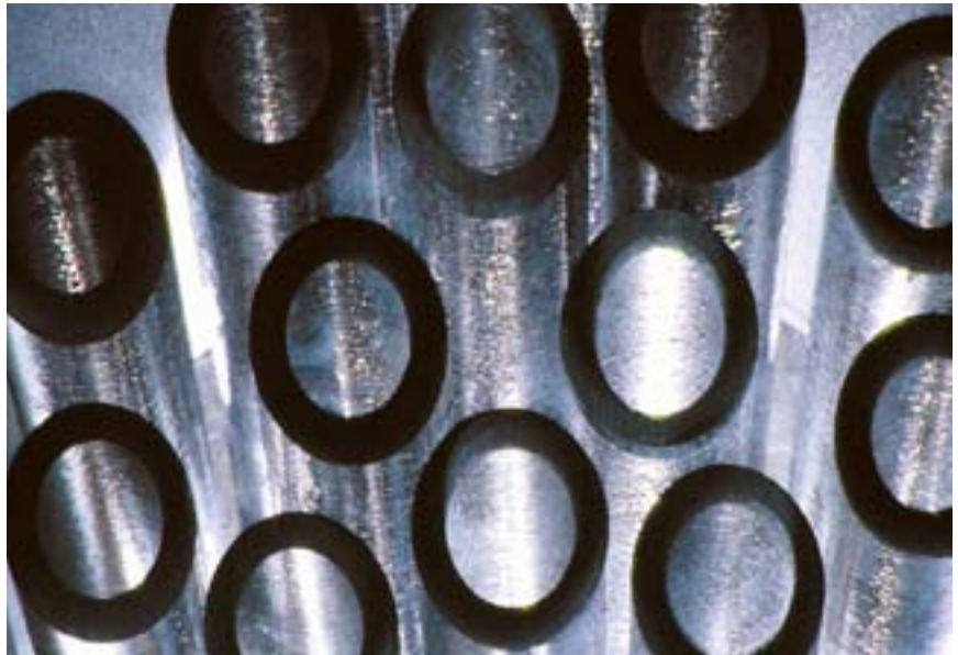
Das Röhrenregister des säureresistenten Keramikwärmetauschers im Brennwertmodul
